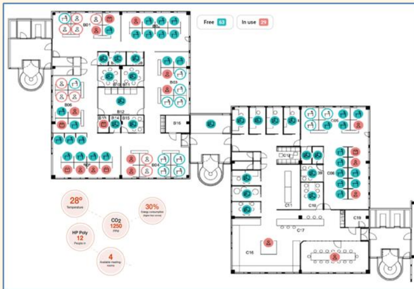
Fra Veritasveien 25, sensorikk som overvåker inneklime og har kontroll på antall brukere og hva som er ledig og opptatt av kontorplasser.
