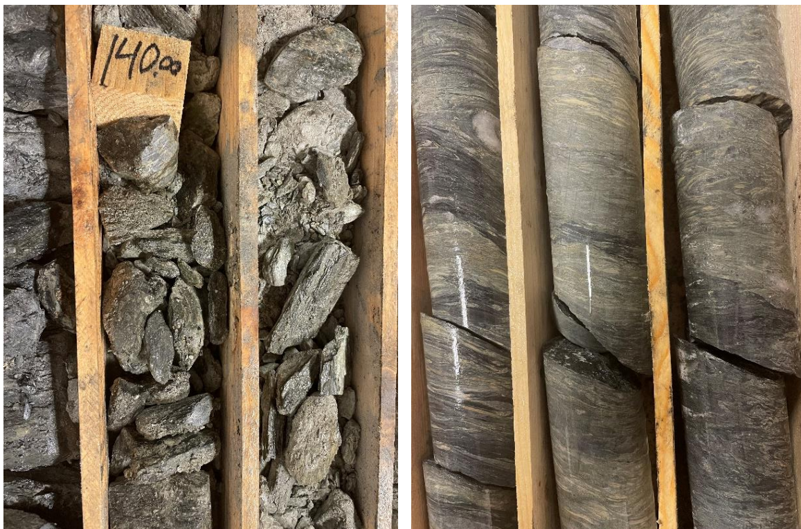
Figur 4 Eksempler på kjernen fra Hundvågstunnelen. Bergarten i kjernene er fyllitt og veksler mellom lyse og mørke lag. Lengden på borekjernene på bildet er ca. 25 cm.
