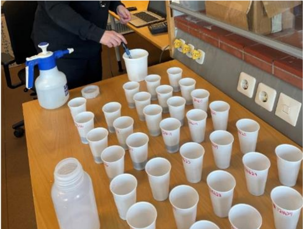
Figur 2 Måling av abrasjons-pH (vann blandet med knust fyllitt).
